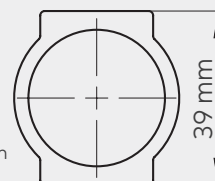
RKPP-SET39P12 Průtokoměr + sedlo Flow meter + lower part • Průtokoměr plast + sedlo 1/2" x 1/2" se šroubením pro AL-PEX 16 mm. • Plaster flowmeter + seat/lower part 1/2" x 1/2" with union for AL-PEX 16 mm.
